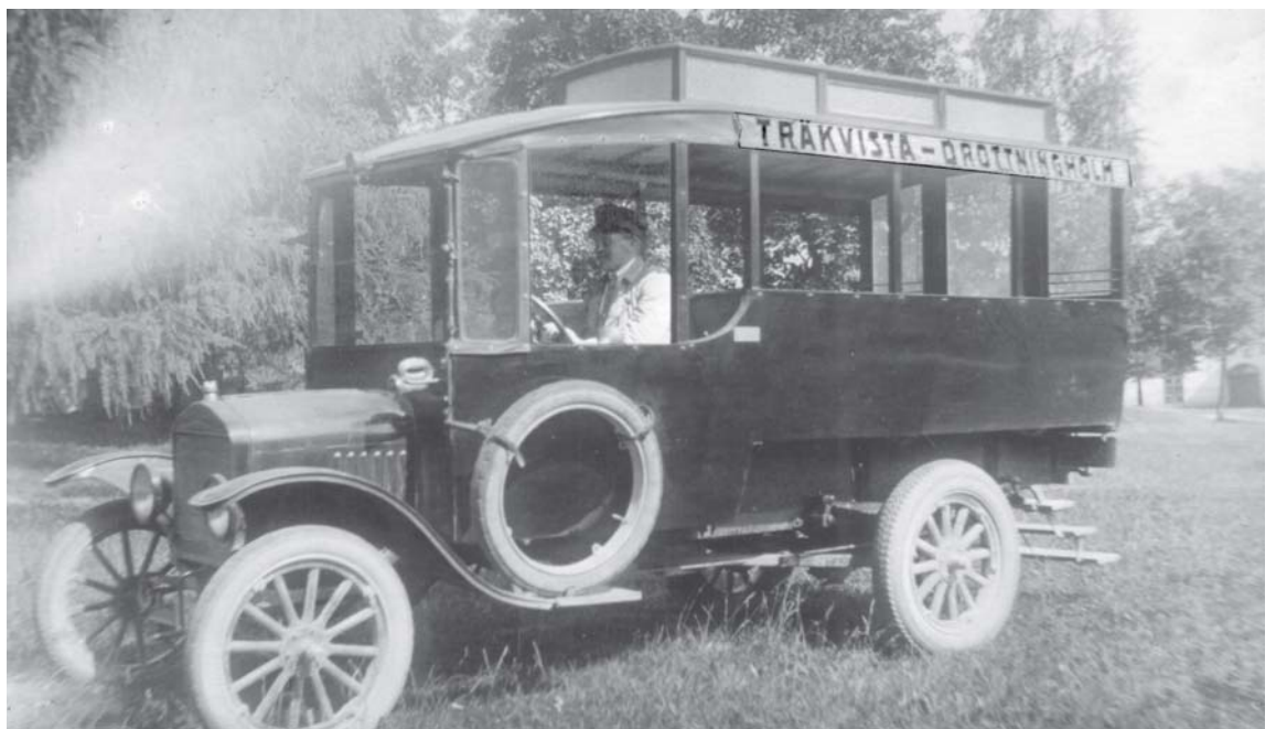
Denna "omnibuss" gick i trafik mellan Träkvista och Drottningholm i början av 1920-talet. Det var en T-Ford som byggts om till buss.
