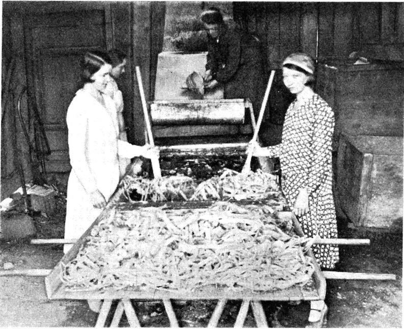
Bild 5. Bilden är från Sveriges sista vaxblekeri, Hanna Sandells vaxblekeri i Sävsjö, och visar smältpannan, cylindern, bassängen och i förgrunden de långa vaxstrimlor, som sedan lägges ut till blekning.
