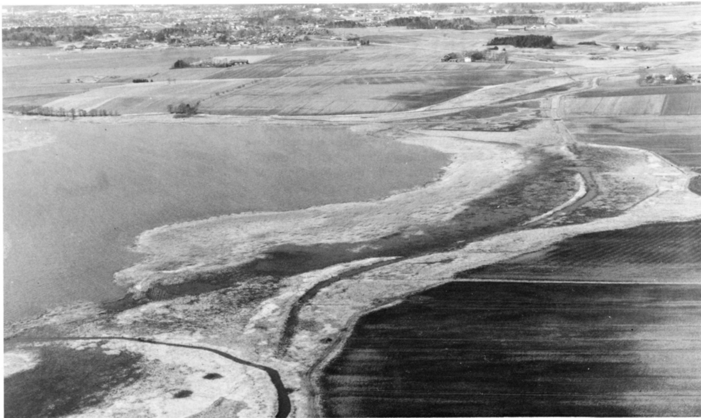
Från luften ses här norra delen av Hullsjön med Kårebrobäcken i förgrunden utrinna åt vänster i bilden. Här i artikeln benämns denna bäck för Fristorpsbäcken. Åt höger ses den kanal som grävdes inför torrläggningen och avsåg leda bäckvattnet förbi sjön för att ansluta sjöns forna också nygrävda utlopp. I förgrunden ses en utkiksplattform för den fågelintresserade.
