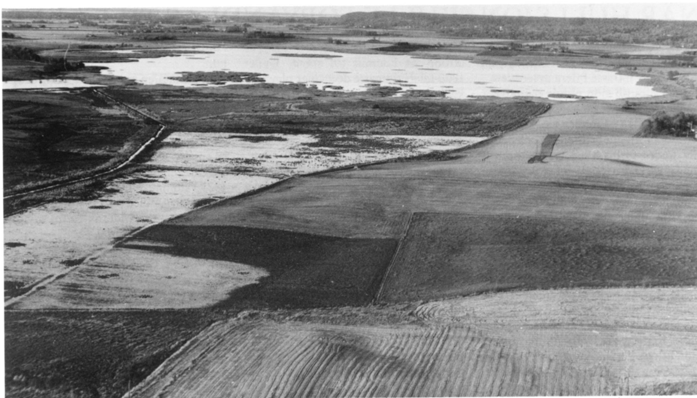
Ankommande vatten söderifrån längs den här i artikeln benämnda Rustorpsbäcken, av Birger Olsson på Sjögården kallad Artorpsbäcken men vanligen kallad "åna" avsågs ledas genom dikning längs västra sjökanten där ännu kanalbankar kan ses. Det gamla utloppet vid "Duppla" ersattes med ett nytt från den grävda kanalen efter att företaget misslyckades.
